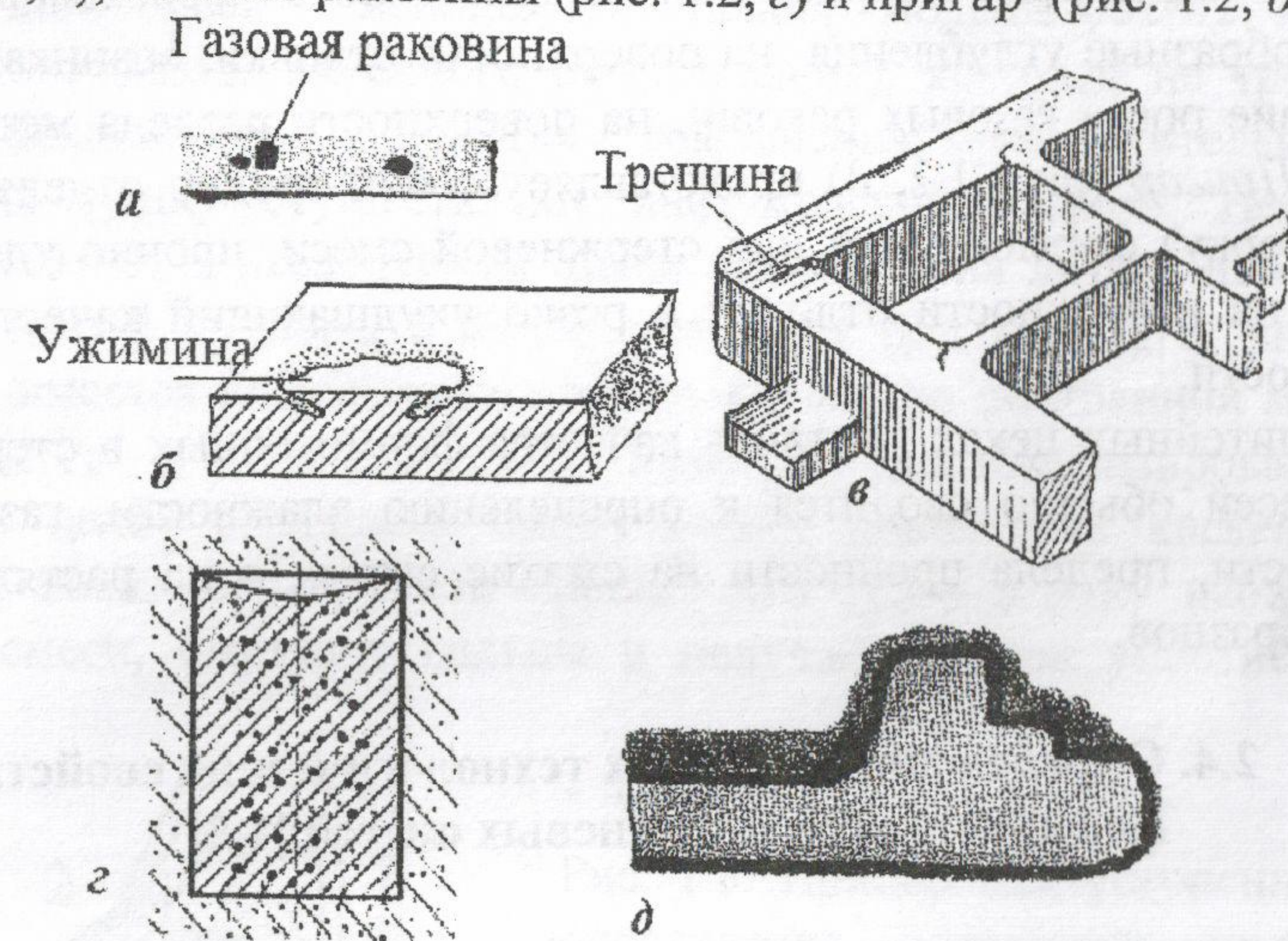
Рис. 1.2. Дефекты в отливках: a – газовые раковины; b – ужимины; в – трещины; г – газовая пористость; d – пригар
